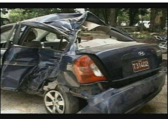
Vista posteriore dell'auto dove si vede molto bene l'impatto laterale dell'urto contro l'albero
