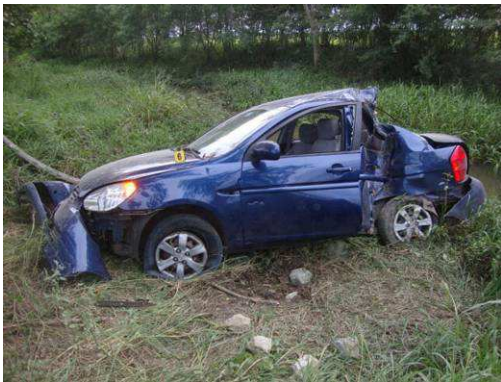
Il forte impatto ha deformato sostanzialmente il telaio e il tetto dell'auto
